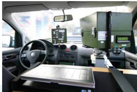
Система PoliScan speed , установленная на месте переднего пассажира ...
